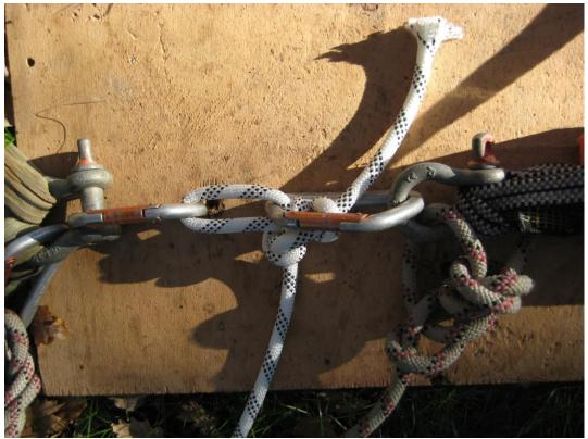
Résultat : glissement à partir de 300 DAN jusqu'à 1000 DAN (sur 15 cm environ) , puis verrouillage du nœud et rupture à + de 2500 DAN dans le nœud.
