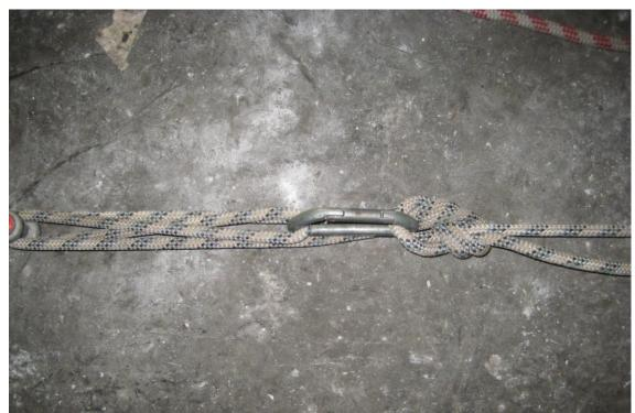
Résultat : Rupture de la corde à 1900 DAN dans le nœud de 9. Pas de glissement ni de signe de faiblesse dans le « huit répartiteur ».
