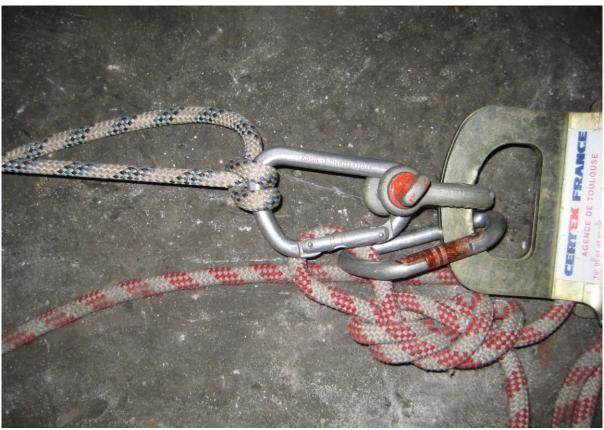
Résultat : Rupture de la corde dans le nœud à 1560 DAN sans glissement.
