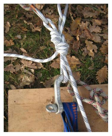
4h) Test nœud de 8 avec une grande ganse reprise en répartiteur avec un mousqueton dans la partie supérieure du nœud (technique GRIMP)
