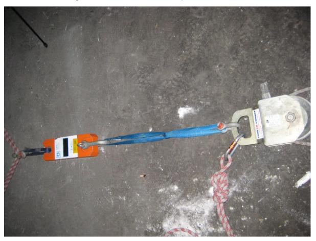
Résultat : Rupture : 1507 DAN dans le nœud de réglage.
